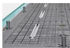
Système de table en aluminium et PVC. Aspiration sur 6 zones à commande manuelle. Zone de bridage mécanique sur les deux côtés de la machine en complément de la dépression.
